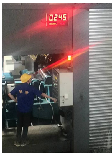
圖片內的 0.245 表示正在生產厚度為 0.245 毫米的冷軋鋼卷
